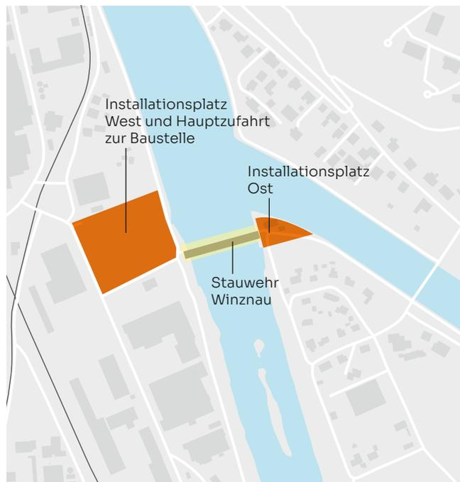
Damit das Stauwehr seine Funktion unterbrochsfrei und sicher erfüllen kann, wird es etappenweise saniert. Die wesentlichen Bauarbeiten sind voraussichtlich Ende 2027 abgeschlossen. Sie betreffen das Restwasserkraftwerk, den Fischaufl-/abstieg, die neue Brücke, das Dammbalkenlager und die Verstärkung der Flusssohle am Wehrfuss (sog. Kolkschutz).
